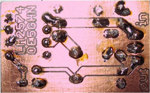
Die fertige Platine, 19 x 30mm, sieht noch unscheinbarer aus als das Layout.
