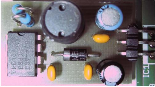
Bei den Bauteilen sollte man auf gute Qualität achten. Die beiden Elkos, die Spannungsfestigkeit richtet sich nach der maximalen Ein- und Ausgangsspannung, sollten Low-ESR-Typen sein. Die Spule ist von Reichelt (09P 330µ) und größenmäßig das dominierende Element.
