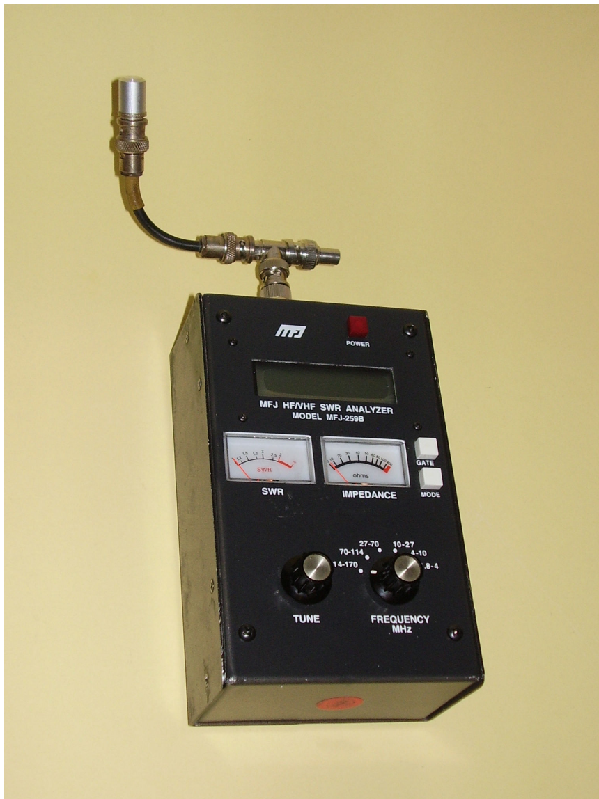
Bild 1: Meßaufbau mit T-Stück und 50 bzw. 75 Ohm Abschlußwiderstand parallel geschaltet
