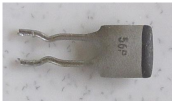
Abb. 11: Keramischer NP0-Kondensator (schwarze Kennfarbe)
