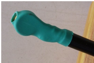
Abb. 15: Eine Koppelsonde zur Messung der Oszillatorfrequenz
