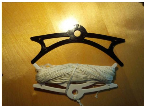
Abb.6: Haspel für Abspannseil oder Antennendraht
