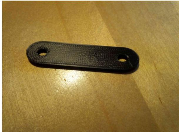
Abb.8: Isolator für Portabelantenne
