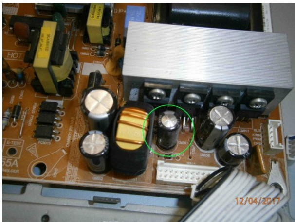
Abb. 2: Netzteil-Leiterplatte, fehlerhaftes Bauteil ist markiert
