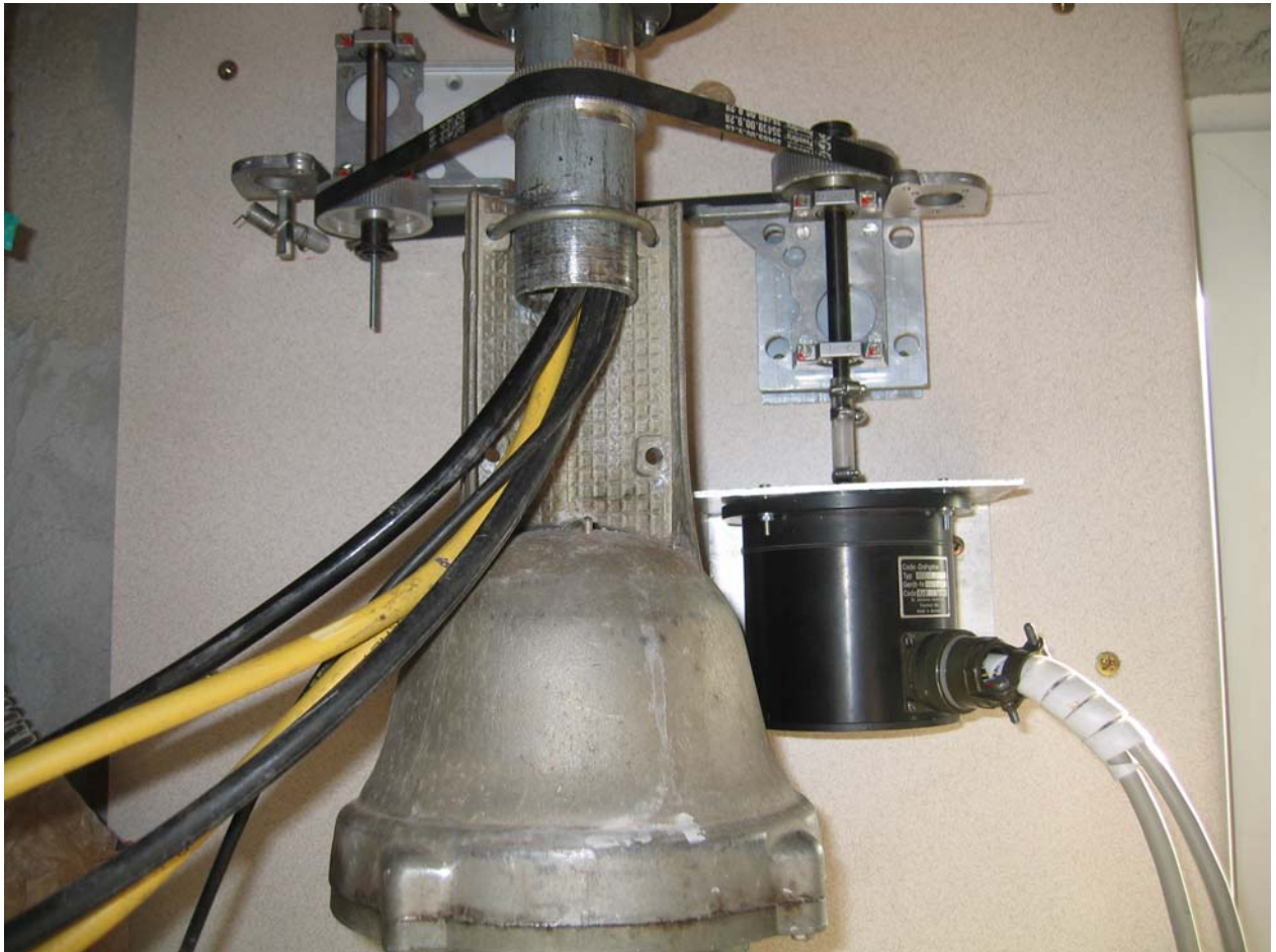
Bild 10, Rotor, Drehgeber, Zahnriemen
