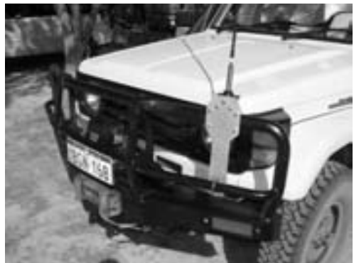
Vertikalantenne MFJ montiert am „Bullbar“ des Campers
