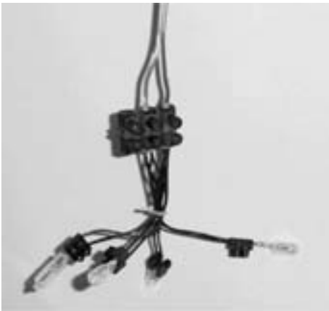
Bild 9: „Belastungswiderstand“ für 18 Ampere bei 12 Volt
