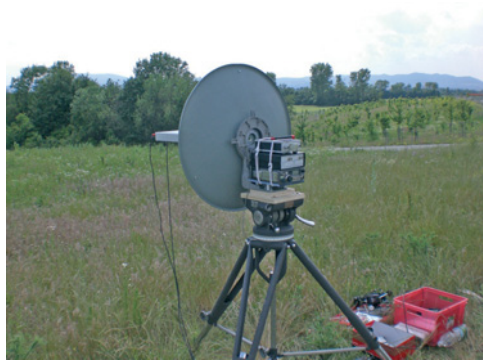
OE3WRA mit 122-GHz-Transverter
