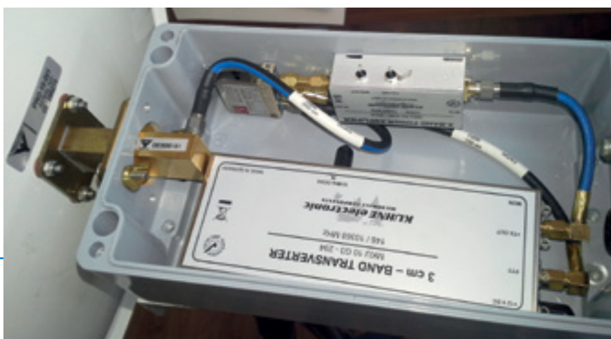
Anordnung der Transverterbaugruppen im Gehäuse
