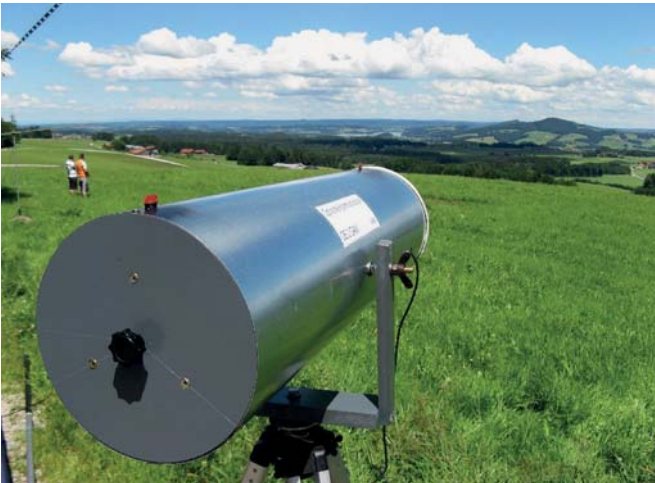
Der Infrarotempfänger zum Übertragungstest mit Licht, die Größe des Empfängers resultiert aus den Abmessungen der Sammellinse und einem großzügigen Schutz gegen störenden Lichteinfall
