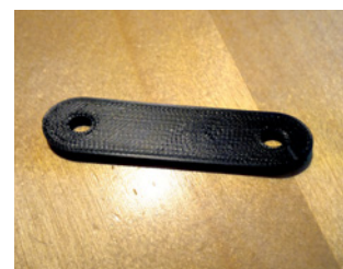
ein Isolator für die Portabelantenne (z. B. Dipol)
