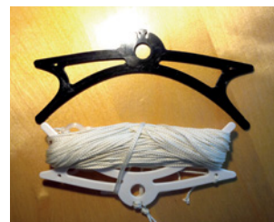
Haspeln für Antennendraht und/oder Abspannseile
