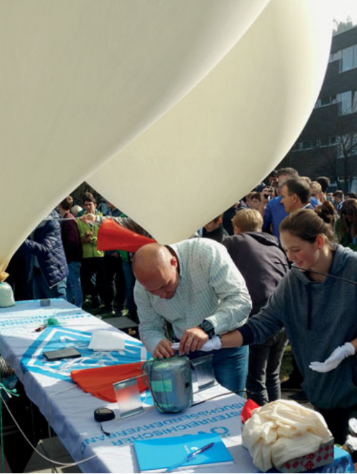
Kurz vor dem Start werden die beiden Nutzlasten an den mit Helium befüllten Freiballonen befestigt.
