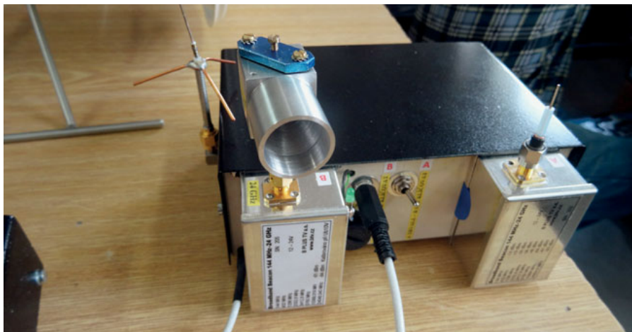
Bild 11: duales Multiband Beacon Modul mit Antennen
