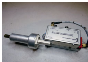
24GHz DB6NT subharmonic mixer mit NORT PLL in Verwendung bei OE3WRA
