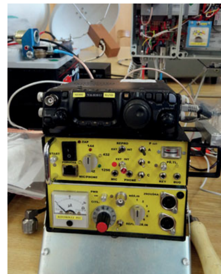
rechts Bild 8: VHF/UHF Multiband Transverter
