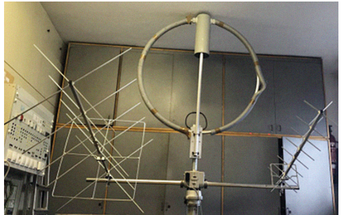
Antennenaufbau Magnetic-Loop und XQuad für 2m und 70cm
