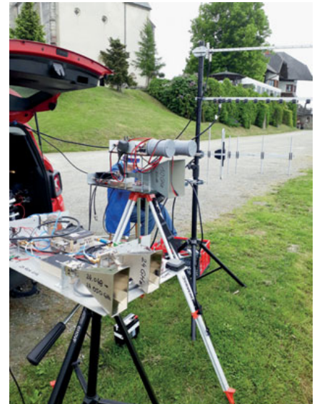
Multiband Station von Erwin OE8EGK im Mai 2018 am Magdalensberg, QRV auf 8 Bändern von 144Mhz bis 24Ghz
