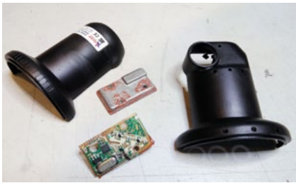
oben: der LNB in seinen Einzelteilen, die Außenschale muss abgezogen werden. Der 27 MHz SMD Quarz ist eindeutig zu erkennen.
