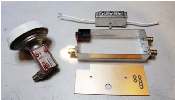
Mechanische Anordnung (Prototype) des Triplexer, der Board selbst hat nur wenige Bauteile aufzunehmen, für die Beschaltung dieser wenigen SMD und bedrahteten Bauteile wurden einfache Lötinseln in das doppelseitige FR4 gefräst.
