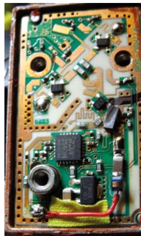
oben: Board mit ausgebautem SMD Quarz (nicht ganz leicht zu entfernen, Heißluft verwenden!)
