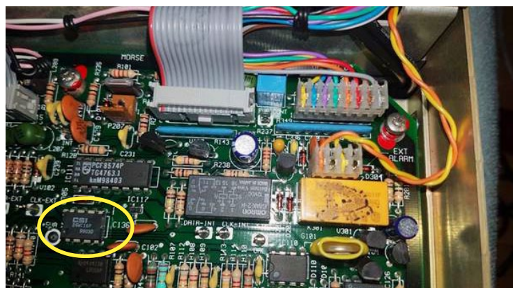
Abbildung 3: Platine des CODAN 9360 (bedrahtete Version) – der zu tauschende Chip ist gelb umkreist.
