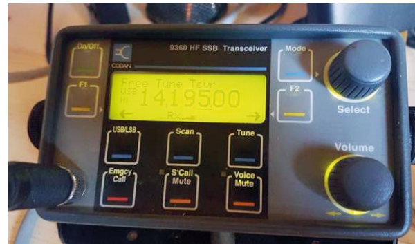
unten Abbildung 2: Bedienteil des CODAN 9360 mit „Free Tune Tcvr“-Mode nach dem Chip-Tuning
