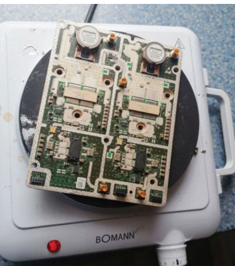
links und unten: vorsichtig mit der Kochplatte erwärmen und dann mit Heißluft bearbeiten
