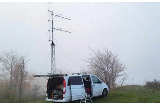
Wenn zwei Busse zur Verfügung stehen, werden die Bänder auf zwei Masten aufgeteilt
