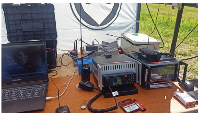
Das Shack im Zelt – Adalm Pluto SDR, Software Portsdown via Raspberry, 20W PA von SG Labs
