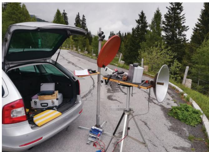
OE8FNK/P am Dobratsch auf 1711 m im Alpe-Adria UHF/SHF Contest beim Betrieb auf 13cm, 9cm und 6cm mit dem selbstentwickelten „El Cuatro“ sowie 3cm mit DB6NT Transverter.
